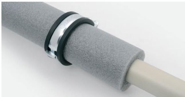
Meleg víz esetén a bilincset egy dimenzióval nagyobb szigetelésre telepítjük
